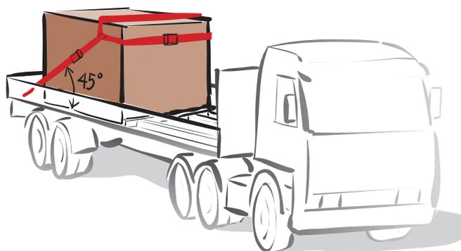
L'imbragatura diagonale può essere eseguita in vari modi ma la regola fondamentale da rispettare è che l'angolo fra i tiranti o le cinghie e la piattaforma, non superi i 45°. Un'imbragatura diagonale perde la sua efficacia quando l'angolo supera i 45°. Le tabelle incluse nel manuale sono state redatte tenendo in considerazione un angolo di 45°.
