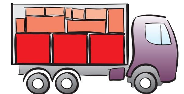
*I carichi pesanti devono essere posizionati ad un livello inferiore rispetto a quelli più leggeri. Questo fa sì che si riduca il rischio di danneggiamento del carico da parte della pressione di merce più pesante ed, in generale, abbassa il centro di gravità del carico. Il centro di gravità di un singolo collo deve essere situato nel punto più basso possibile in modo da prevenire il rischio di ribaltamento.*
