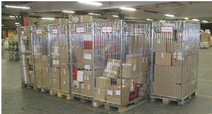
Per il carico generico di piccole dimensioni vengono spesso utilizzate le casse anche perché ogni destinatario ha la propria. Il sistema più usato per ancorarle è bloccandole. Questa operazione viene svolta sistemandole una contro l'altra o contro strutture del veicolo. Nel lato posteriore poi vengono, solitamente, rizzate con cinghie o tiranti.
