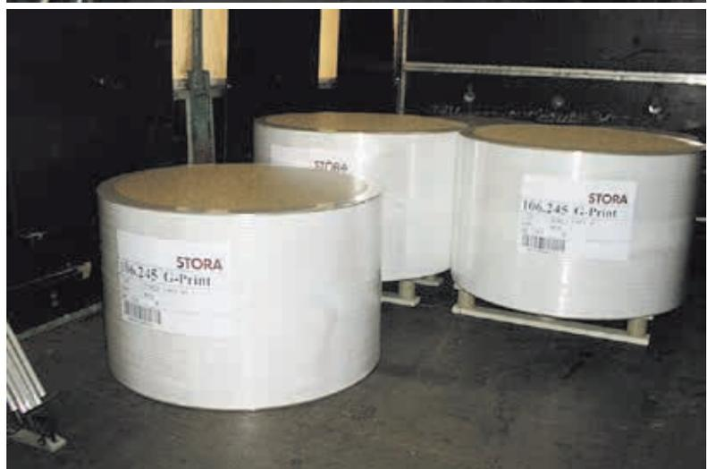
Bloccare i pallet di carico generico è un procedimento che è stato reso più semplice, visto che le dimensioni delle piattaforme di carico sono basate sulla lunghezza e larghezza di un pallet standard (I.S.O.). In altre parole la larghezza della piattaforma è pari o alla somma della larghezza di due pallet grandi, o alla somma della larghezza di tre pallet piccoli.
