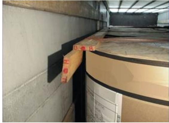
Travi di supporto possono anche svolgere funzione di protezione. Essendo lunghe e stabili distribuiscono in modo uniforme la pressione dei vari sistemi di rizzaggio. Questo sistema si può impiegare anche quando il carico consiste in un numero elevato di pacchi piccoli e leggeri.
