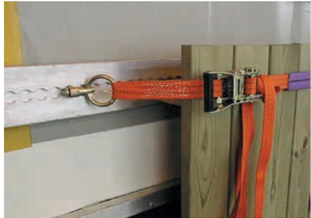
I punti di ancoraggio sul mezzo di trasporto devono, secondo la maggior parte degli standards, avere un carico di rottura minimo pari a 2 tonnellate; questo però, risulta essere al quanto basso visto che un comune mezzo per assicurare il carico risulta avere un carico di rottura di 4 tonnellate.
